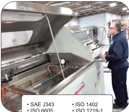
Essais de pression jusqu'à 6 flexibles à 1000 BAR
