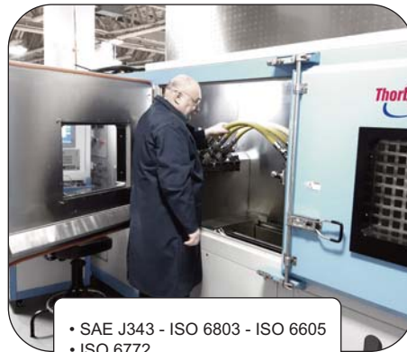
Essais de flexion-impulsion jusqu'à 700 BAR à 150°C
