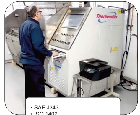
Essais d'éclatement jusqu'à 4000 BAR
